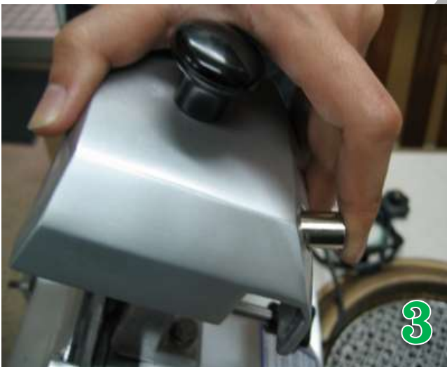
3 將刀刀至於兩片磨刀石中間 再將後方螺絲做固定
