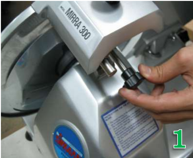
1 逆時鐘將後方刀盤護蓋螺絲鬆開
