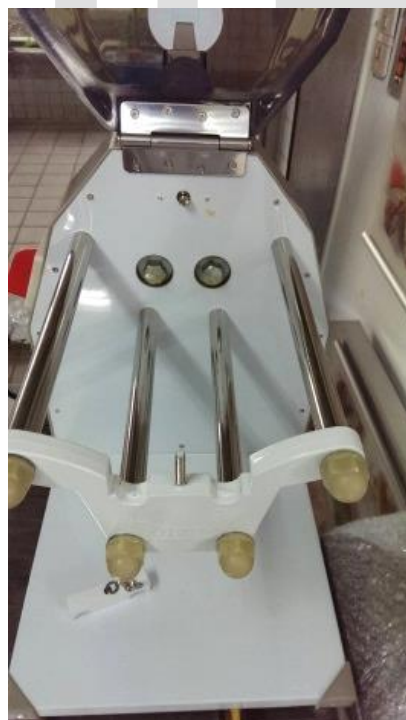
4. 刀刃組清洗完畢後組回，內部孔要確實放入，固定座的銅質滾軸會在正中，然後再將蝶型螺絲和固定器鎖上
