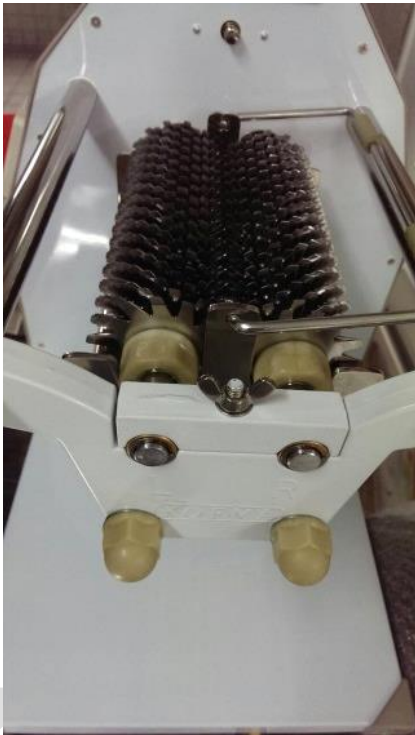
1. 使用完畢後務必清潔刀刃組，將蝶型螺絲旋開，並把固定座取下來，請注意不要遺失
