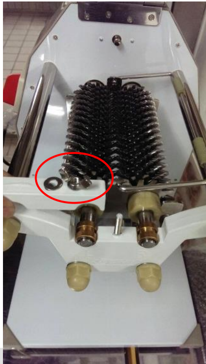
1. 使用完畢後務必清潔刀刃組，將蝶型螺絲旋開，並把固定座取下來，請注意不要遺失
