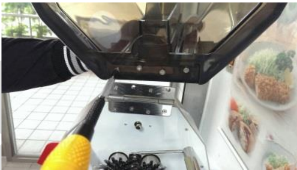
3. 接著把壓克力罩上的四顆螺絲旋下，鎖在機器的門栓上
