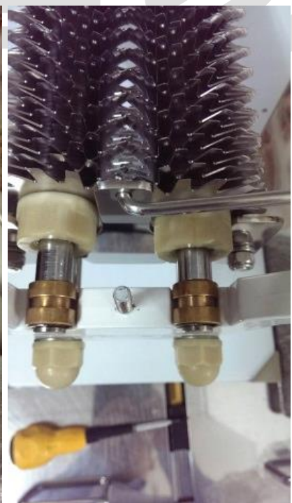
4. 刀刃組清洗完畢後組回，內部孔要確實放入，固定座的銅質滾軸會在正中，然後再將蝶型螺絲和固定器鎖上
